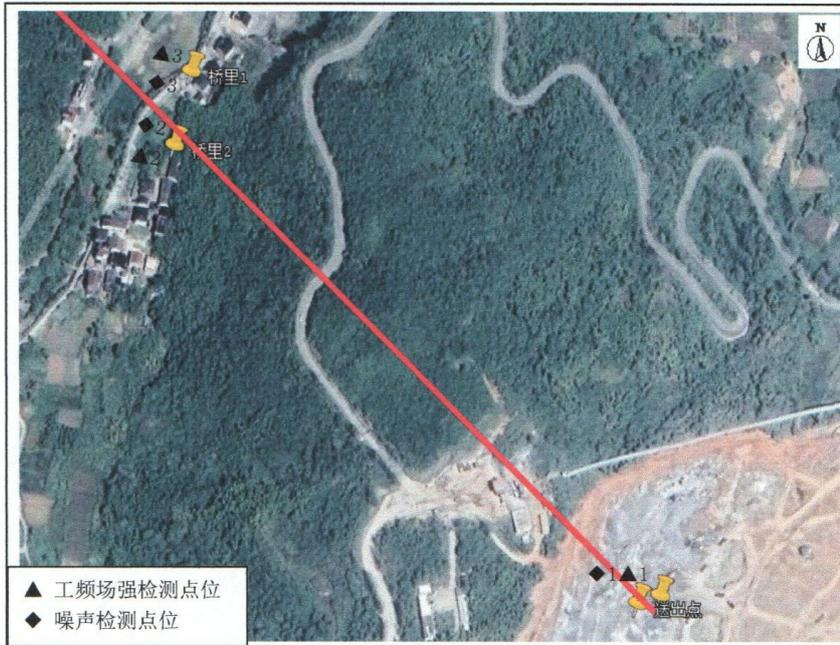
图 1 富阳循环经济产业园垃圾焚烧电厂 110kV 送出工程工频场强及噪声环境检测点位示意图
