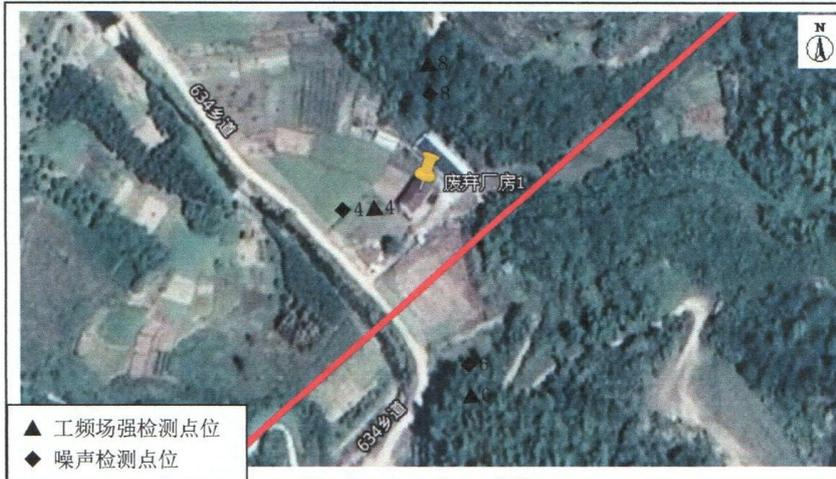
图 2 富阳循环经济产业园垃圾焚烧电厂 110kV 送出工程工频场强及噪声环境检测点位示意图
