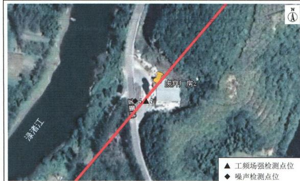
图 3 富阳循环经济产业园垃圾焚烧电厂 110kV 送出工程工频场强及噪声环境检测点位示意图
