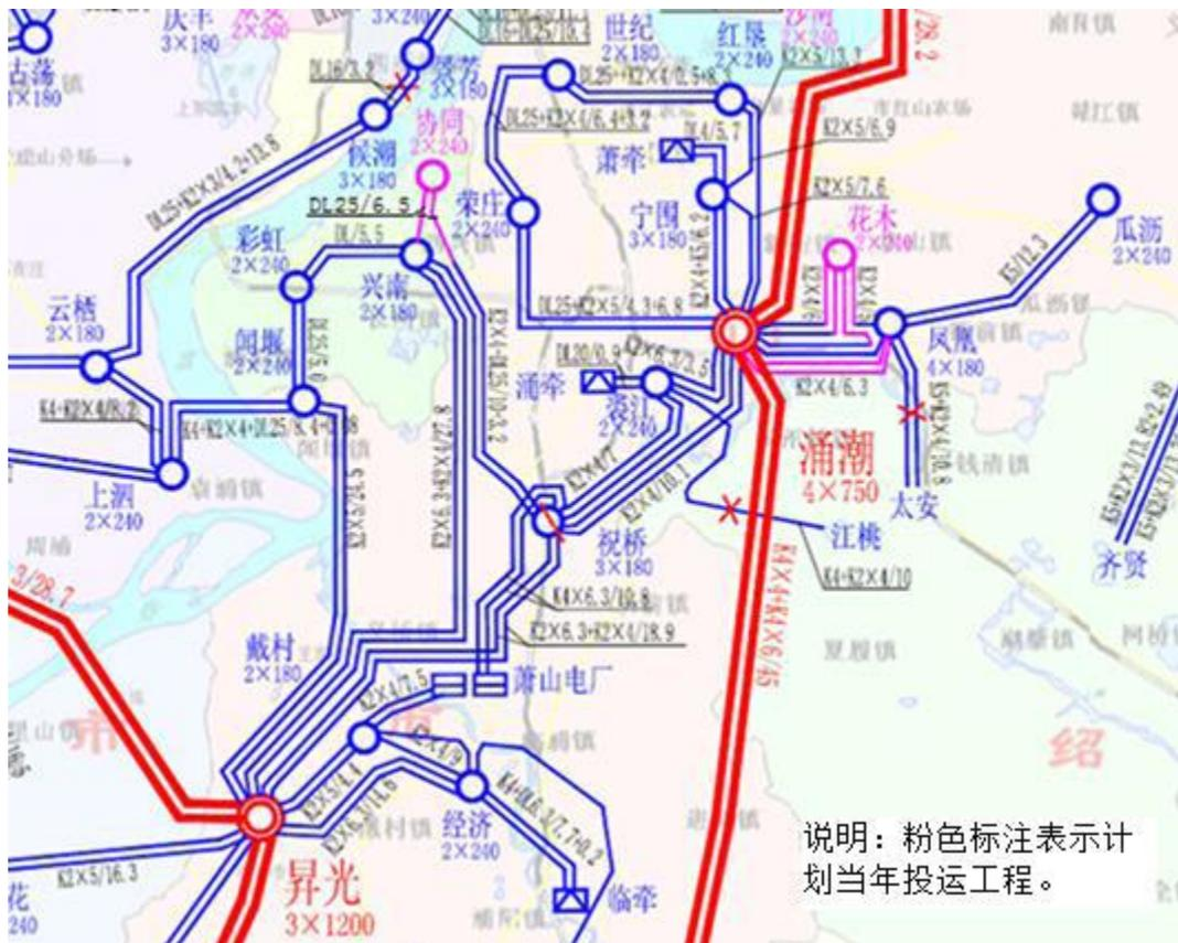
图 9.2-2 协同变接入后 220kV 及以上电网地理接线示意图
