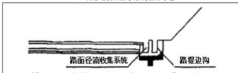
(2) 挖方路段双排水系统设计示意
